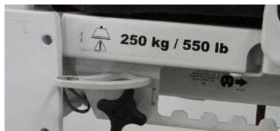
図E - ノブねじで固定されたブラケット
