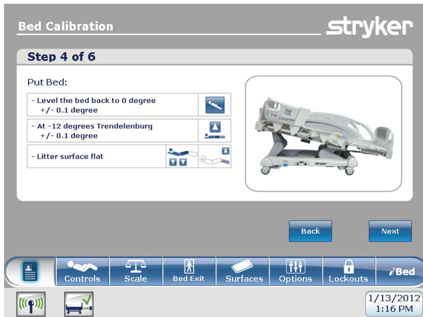
Figure 14 – Étalonnage du lit – étape 4 sur 6
