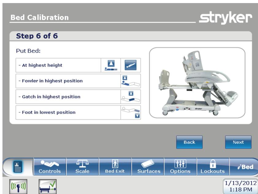
Figure 19 – Étalonnage du lit – étape 6 sur 6
