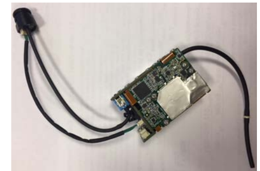
Figure 8.75— MODULE, CO2, NANOMEDICO2, MEDTRONIC, LP15 (Nanomedi CO2 Module) (REF A25).
