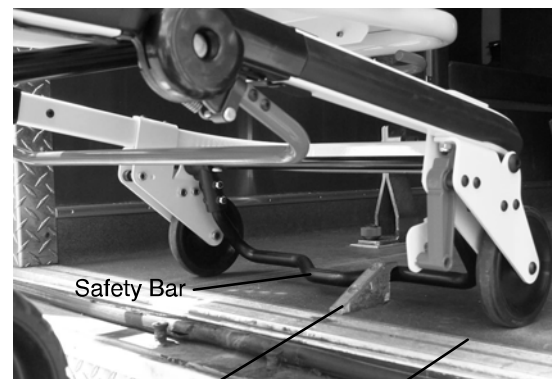
Gancio di sicurezza Spigolo del pavimento
