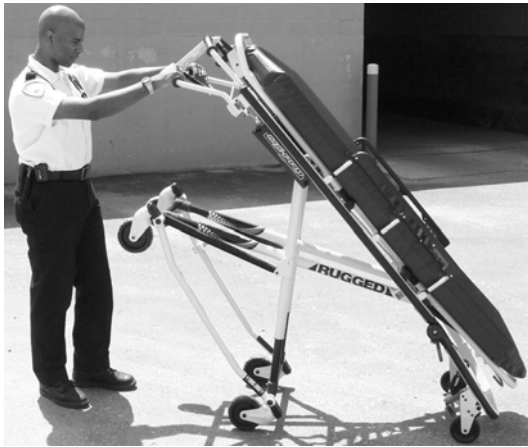
Figur 25 – Vagnen tippad på lasthjulen
