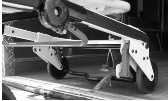
Figure 16 – Engagement de la barre de sécurité du crochet de sécurité
