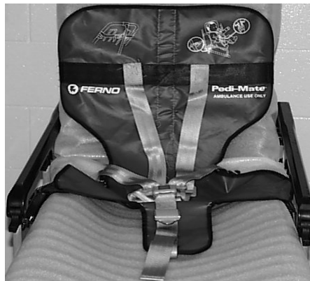
Figure 15 – Pedi-Mate™ fixé à une civière Rugged®
