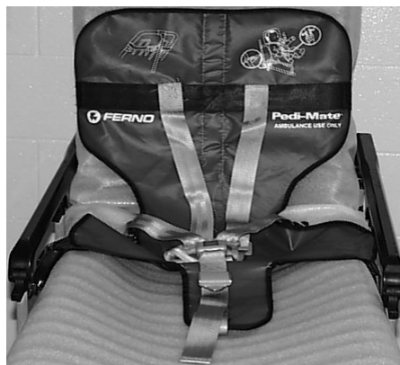
Abbildung 15 – An die Rugged™ Trage geschnallter Pedi-Mate™
