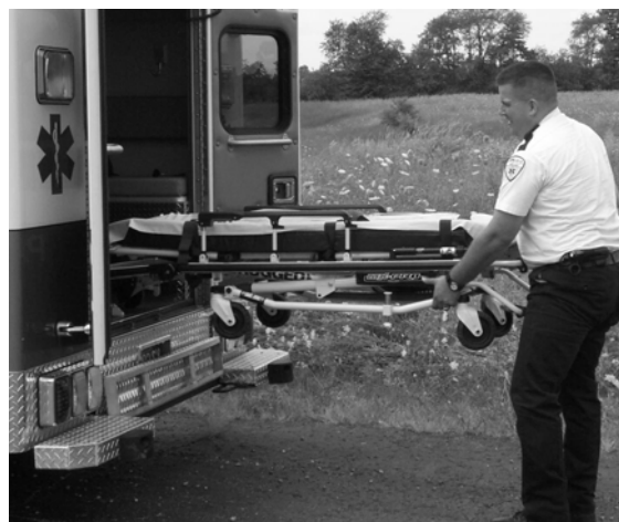
Abbildung 21 – Das Untergestell der Trage nach oben ziehen
