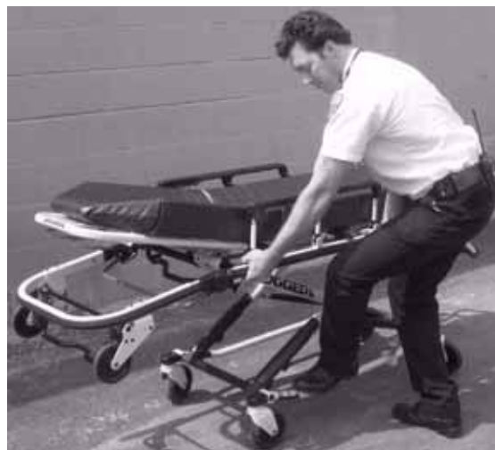
Figur 27 – Håll fast den yttre stödskenan
