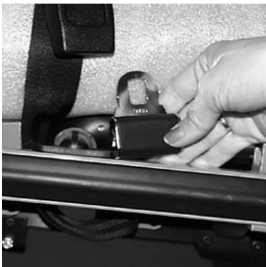
Figura 14 – Fissaggio delle cinture di sicurezza su una barella RUGGED t
