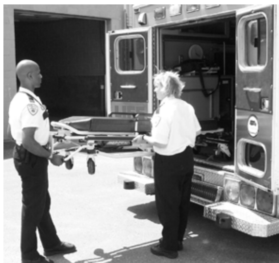
Figura 18 – 2 Operatori – La base è completamente sollevata
