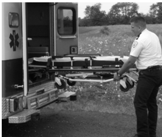
Abbildung 21 – Das Untergestell der Trage nach oben ziehen
