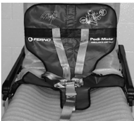
Figur 15– Pedi-Mate t fastspänd på en Rugged t Patientvagn
