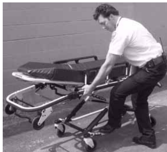
Figura 27 – Presa della sbarra di supporto esterna
