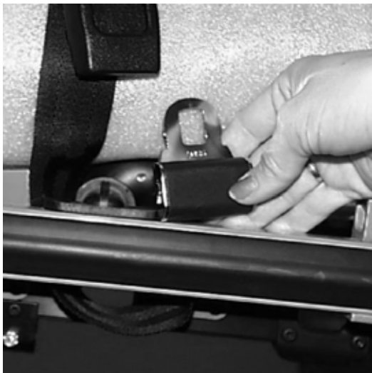
Figur 14 – Fastsättning av selen på en Rugged patientvagn
