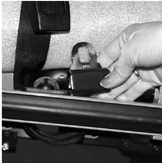
Figura 14 - Sujeción de las correas de seguridad en una Camilla Rugged R
