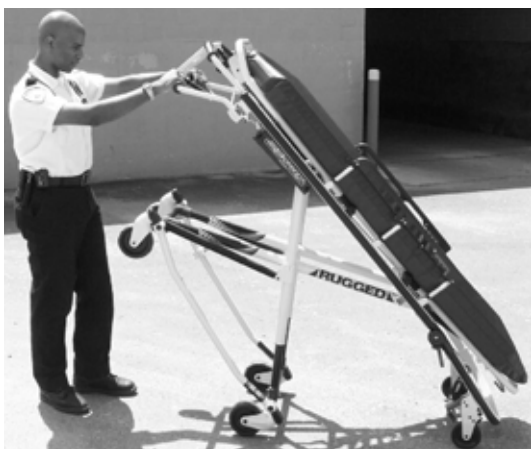
Figur 25 – Vagnen tippad på lasthjulen
