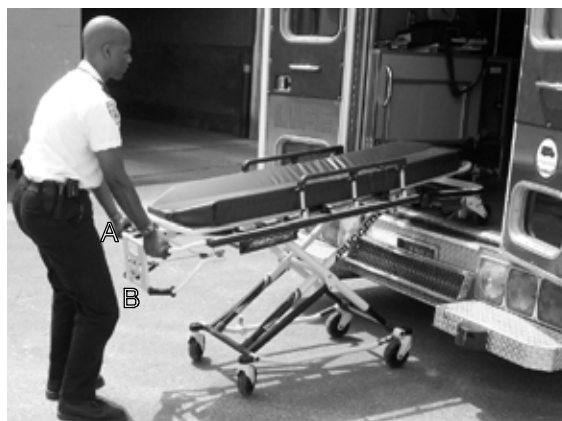
Figura 19 - Apriete la palanca liberadora
