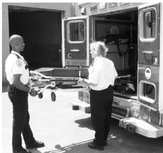
Figura 18 - 2 Operadores - La base completamente arriba
