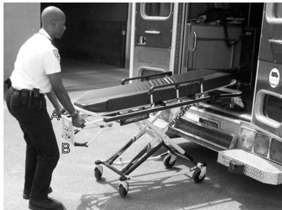
Figura 19 - Apriete la palanca liberadora
