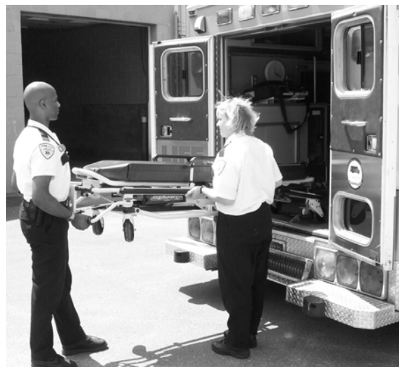
Figure 18 – 2 Opérateurs – La base entièrement élevée
