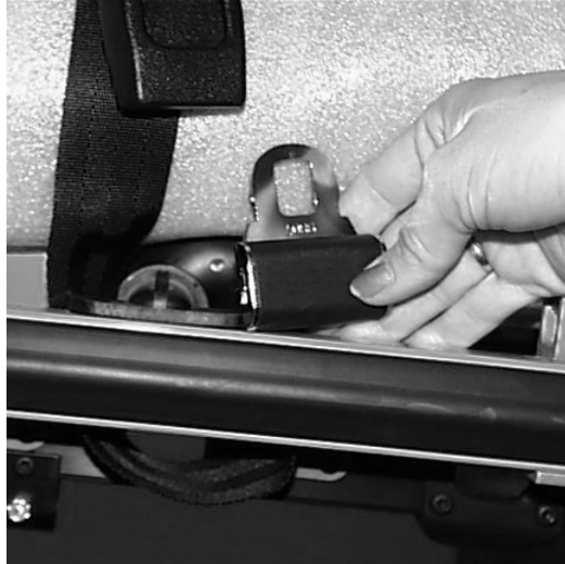
Figure 14 – Attache des sangles de sécurité sur une civière Rugged®
