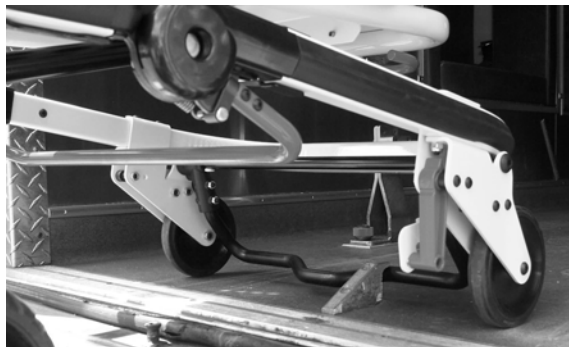
Figura 16 - Barra de seguridad conectada al gancho de seguridad
