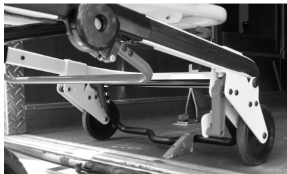
Figur 16 – Skyddsstängningen griper i säkerhetshaken
