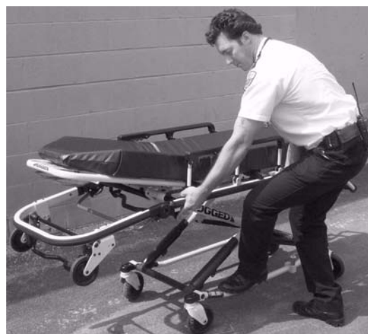
Abbildung 27 - Festhalten an der äußeren Rahmenschiene
