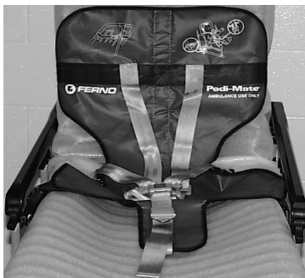
Figura 15 – Il Pedi-Mate™ assicurato a una barella Rugged™
