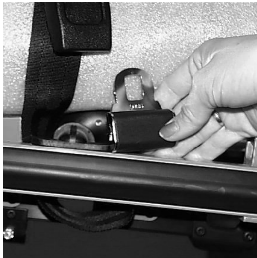
Figura 14 - Sujeción de las correas de seguridad en una Camilla Rugged®
