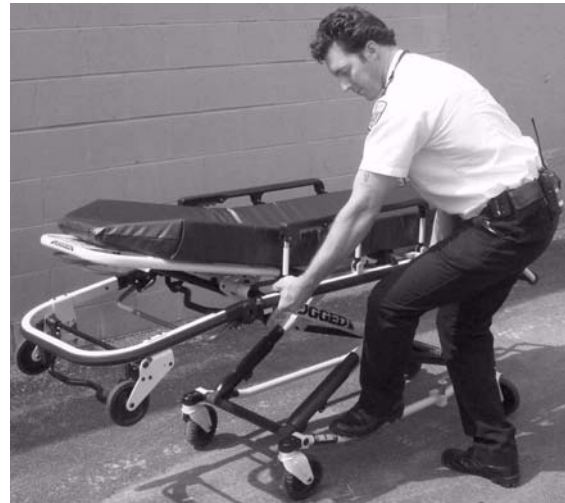
Figura 27 - Sujeción de la agarradera de apoyo exterior
