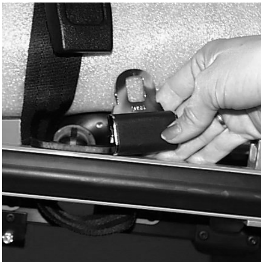
Figur 14 – Fastsättning av selen på en Rugged patientvagn
