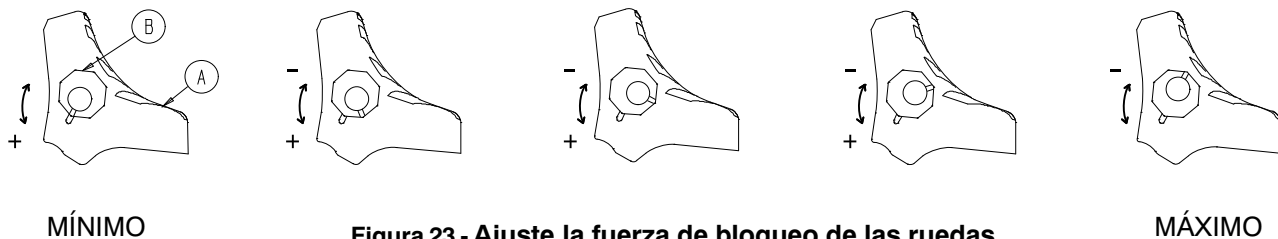
Figura 23 - Ajuste la fuerza de bloqueo de las ruedas
