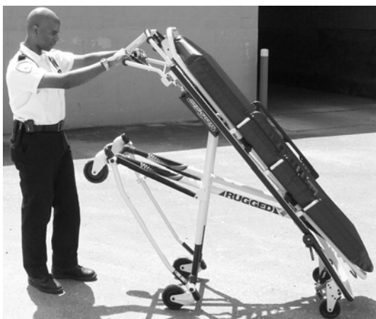
Figur 25 – Vagnen tippad på lasthjulen
