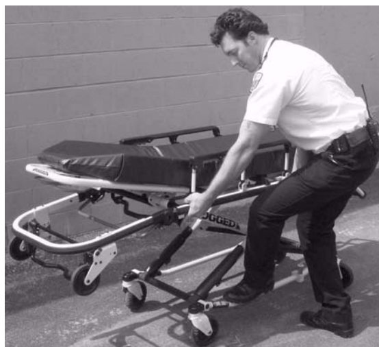
Figure 27 – Prise de la lisse d'appui extérieur
