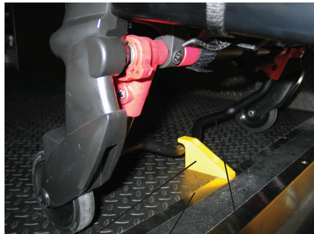
Barra de seguridad fijada al gancho de seguridad
