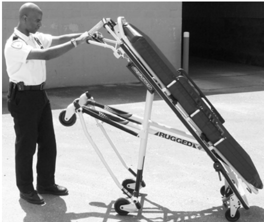
Figura 25 - Camilla inclinada sobre las ruedas de carga
