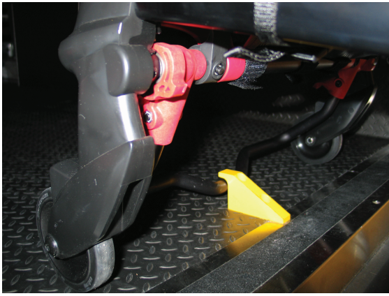
Figure 5 – Barre de sécurité fixée en place dans le crochet de sécurité du véhicule
