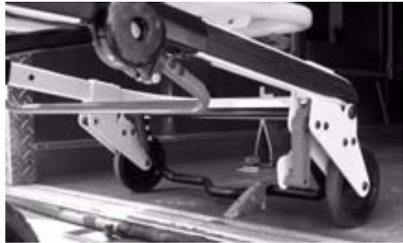
Abbildung 21 – Sicherheitsbügel klinkt in Sicherheitshaken ein
