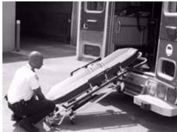
Abbildung 25 – Fußende der Trage absenken
