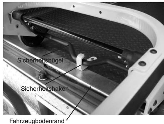
Abbildung 7 – Im Sicherheitshaken eingeklinkter Sicherheitsbügel
