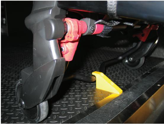
**Abbildung 7 – Im Fahrzeugsicherheitshaken arretierter Sicherheitsbügel**
