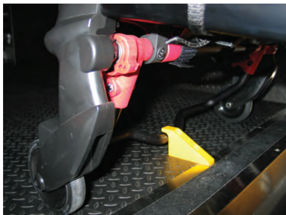
Abbildung 7 – Im Fahrzeugsicherheitshaken arretierter Sicherheitsbügel
