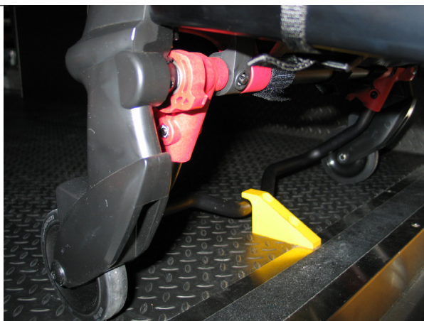
Obr. 18: Zachycení bezpečnostní tyče do bezpečnostní zarážky
