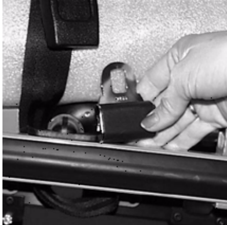
Figura 57: Fissaggio delle cinghie di contenimento alla barella
