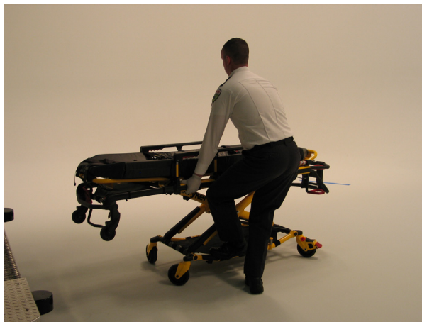
Rysunek 17: Opuszczanie noszy z boku
