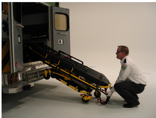
Abbildung 27: Absenken des Fußendes der Trage
