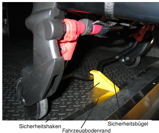
Abbildung 11: Sicherheitsbügel klinkt in Sicherheitshaken ein
