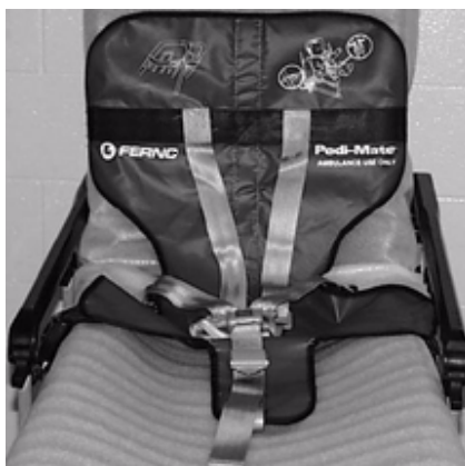
Kuva 58: Pedi-Mate® kiinnitettyä hihnoilla paareihin
