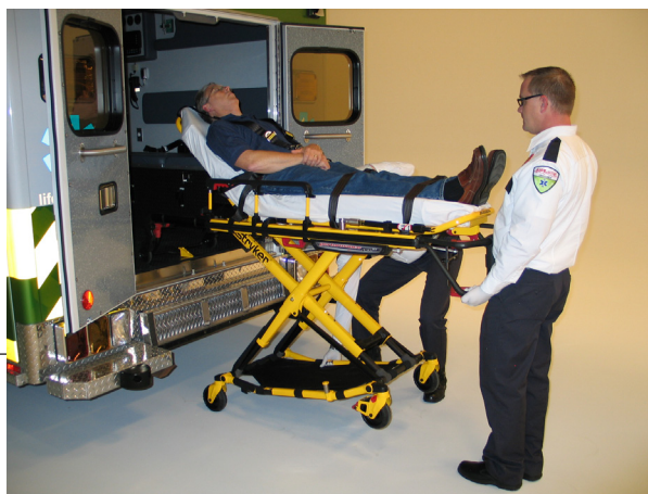
Figura 19: 2 operatori - un operatore solleva la base
