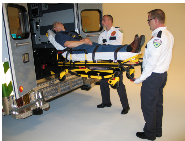
Figura 24: 2 operatori con base sollevata completamente
