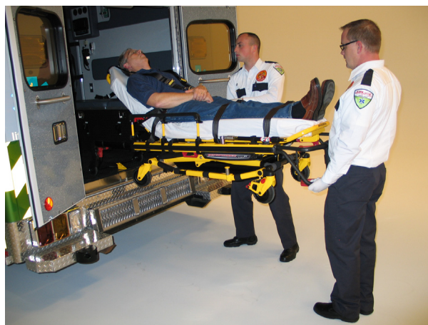
Figura 24: 2 operadores com a base completamente para cima
