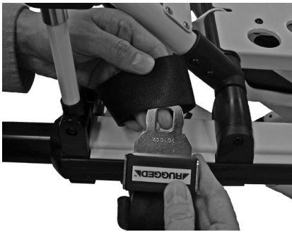
Figura 37: Enrolar a correia à volta da maca
