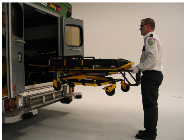
Abbildung 26: Ziehen am Grundgestell der Trage
