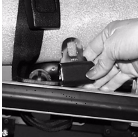
Figur 57: Fastsättning av säkerhetsbältena på en bårvagn
