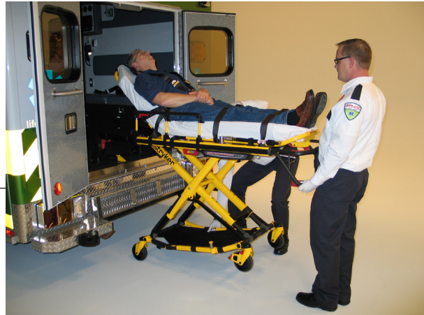
Abbildung 19: 2 Bediener, von denen einer das Grundgestell anhebt
