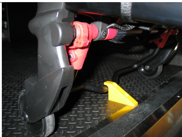
Figur 18: Säkerhetsstänggen ihopkopplad med säkerhetskaken
