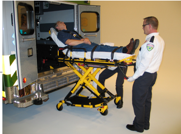
Figura 19: 2 operadores, um a levantar a base
