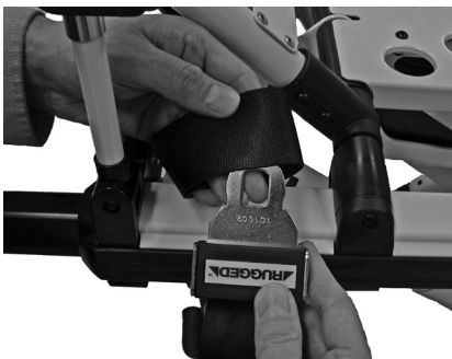
Abbildung 37: Haltegurt am Tragenrahmen sichern
