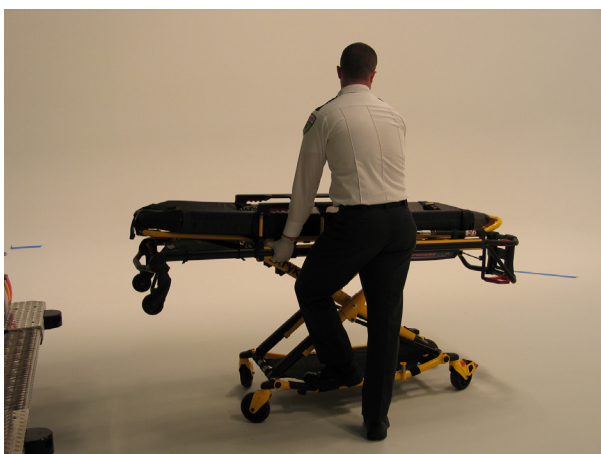
Rysunek 16: Przytrzymanie zewnętrznej szyny wspornika
