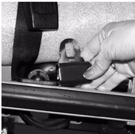
Figura 57: Fijación de las sujeciones de seguridad en una camilla
