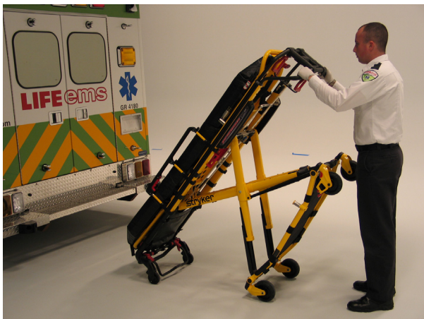
Figura 14: Maca inclinada sobre as rodas de carregamento
