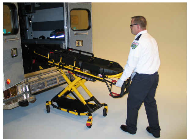
Figur 28: Klem på udløsningshåndtaget
