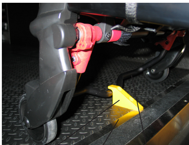
Obr. 11: Zachycení bezpečnostní tyče do bezpečnostní zarážky
