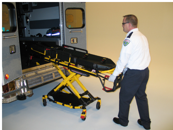
Obr. 21: Stiskněte uvolňovací páku
