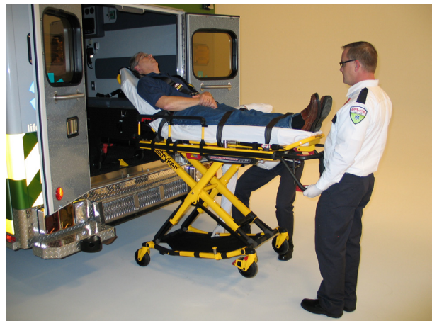
Figura 25: 2 operadores, uno de ellos bajando la base
