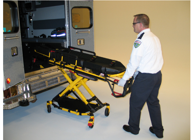
Rysunek 21: Ścisnięcie uchwytu zwalniającego
