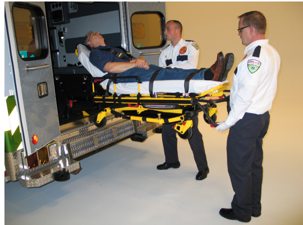
Figura 24: 2 operadores con la base completamente levantada
