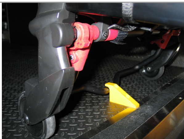
Rysunek 18: Pręt bezpieczeństwa załączony w haku bezpieczeństwa
