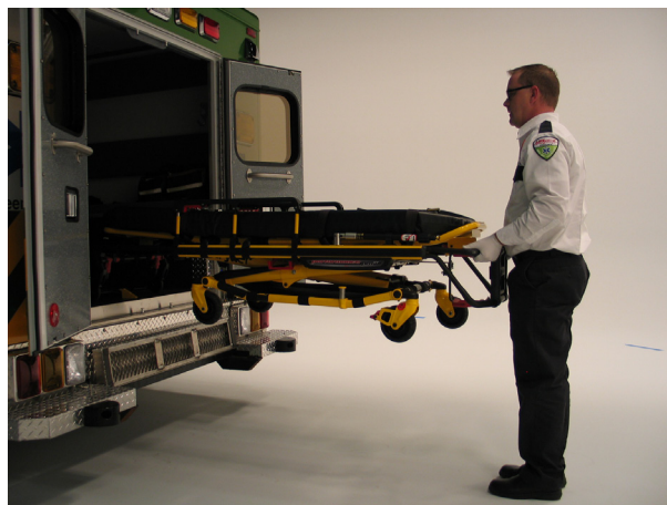
Abbildung 23: Hochziehen des Grundgestells der Trage
