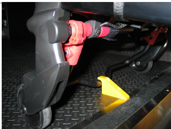
Kuva 18: Turvatangon kiinnittyminen turvakoukkuun
