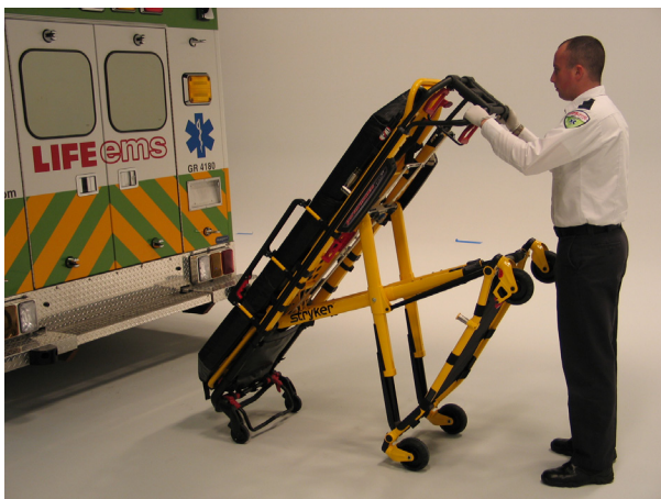
Obr. 14: Lůžko převrácené na nakládací kola
