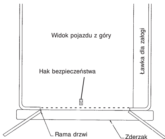
Rysunek 10: Umieszczenie haka bezpieczeństwa (tylko w celach informacyjnych)
