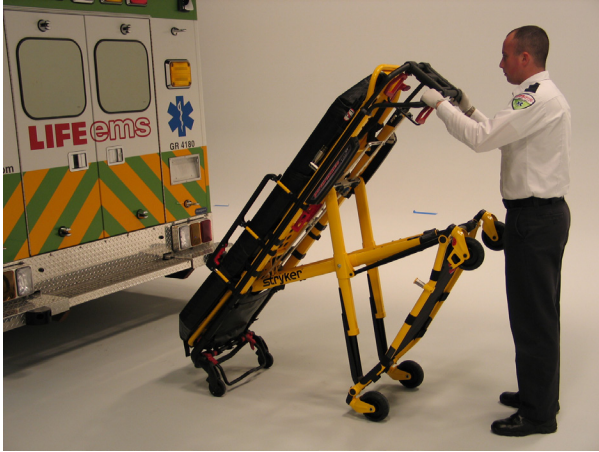
Figura 14: Camilla inclinada sobre las ruedas de carga
