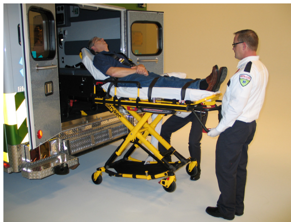
Figura 25: 2 operatori - un operatore abbassa la base
