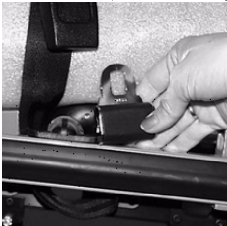
Figure 57 : Fixation des sangles de retenue sur une civière
