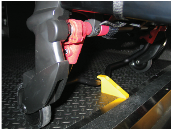
Rysunek 6 – Listwa zabezpieczająca połączona z hakiem zabezpieczającym pojazdu
