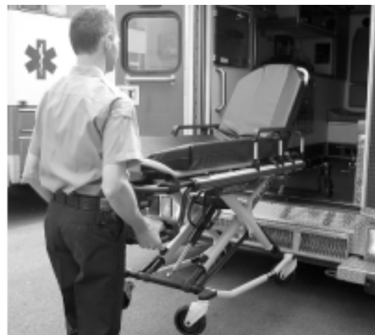
Figuur 50 - Verwijder de laadwielen van de vloer van het voertuig
