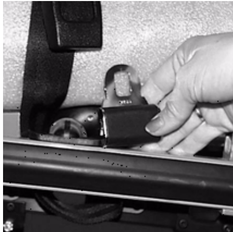
Abbildung 23 - Festschnallen der Sicherheits-Haltegurte an einer RUGGED Trage
