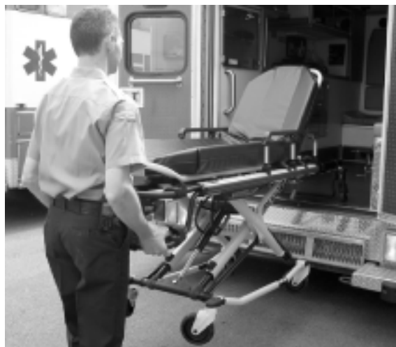
Figura 60 - Allontanare le ruote di caricamento dal pavimento della vettura
