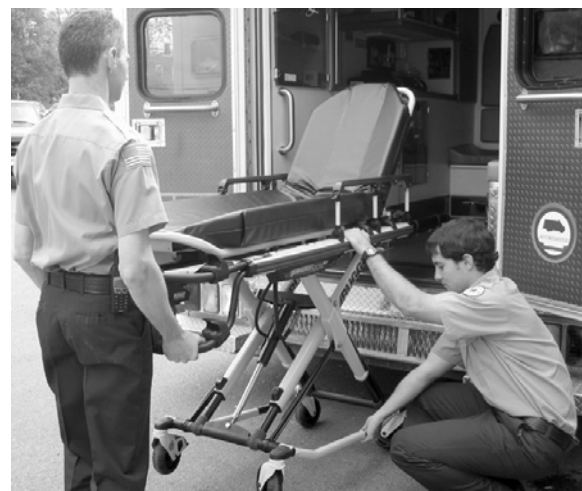
Abbildung 53 - Zwei Bediener, von denen einer das Grundgestell anhebt
