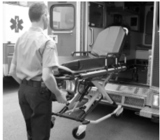
Figur 50 - Avlägsna flyttningshjulen från fordonets golv
