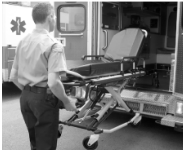
Abbildung 59 - Am manuellen Entriegelungshebel ziehen
