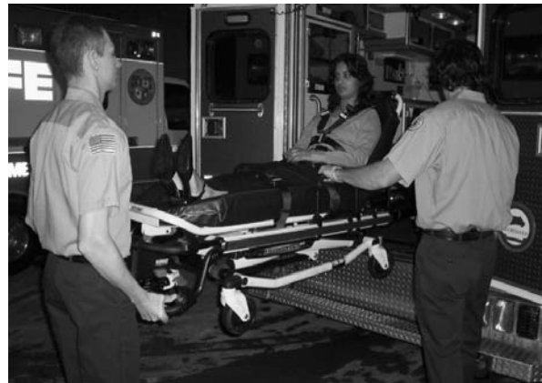
Figuur 55 - 2 bedieners lossen de brancard
