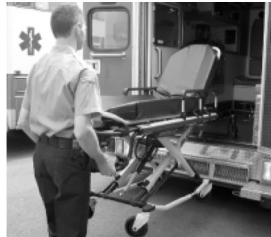
Abbildung 50 - Laderollen vom Fahrzeugboden wegziehen
