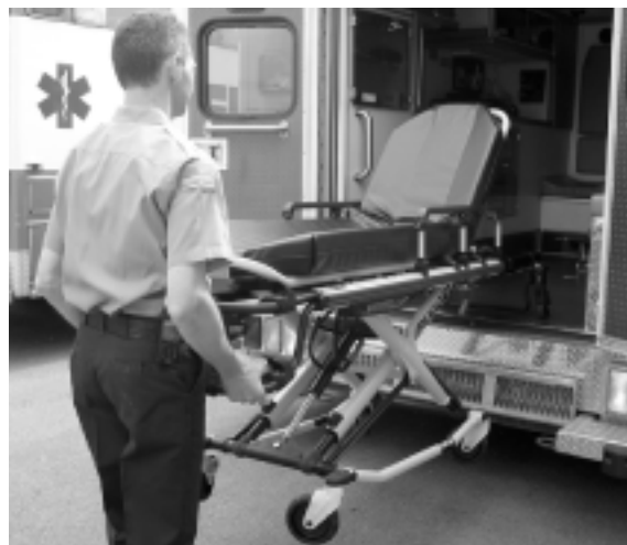
Figur 60 - Avlägsna flyttningshjulen från fordonets golv
