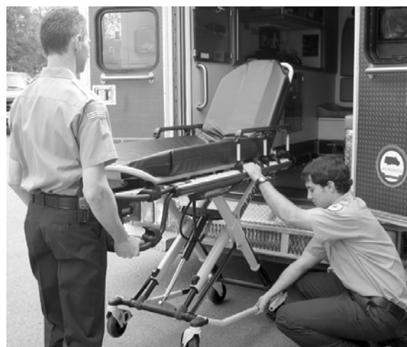
Figur 53 - 2 användare - en lyfter basen
