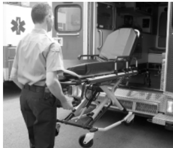
Abbildung 60 - Laderollen vom Fahrzeugboden wegziehen
