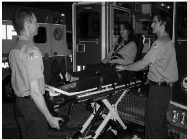
Figuur 40 - 2 bedieners - een bediener duwt op de intrekknop
