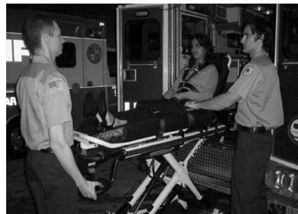
Figuur 56 - 2 bedieners - een bediener duwt op de uitschuifknop
