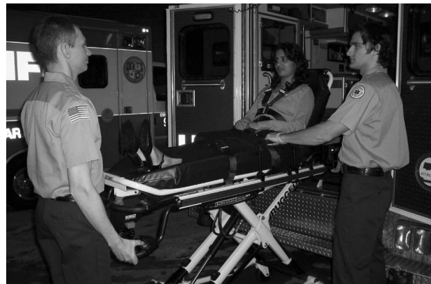
Figuur 46 - 2 bedieners - een bediener duwt op de uitschuifknop
