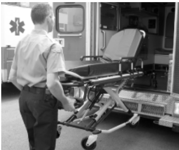
Figuur 59 - Trek aan de handmatige vrijgavehendel
