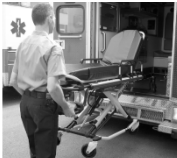
Figuur 42 - Laadwielen op de vloer van het voertuig
