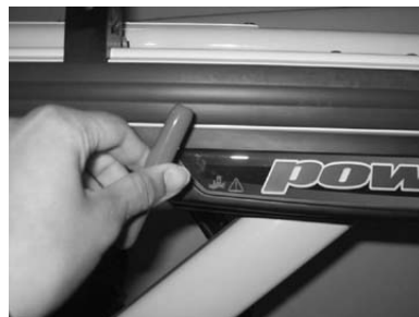
Figuur 4b - De twee schroeven losdraaien
