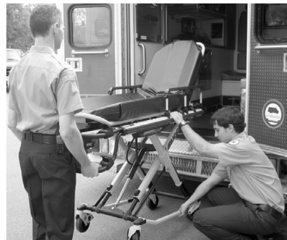
Figure 53 - Deux opérateurs, l'un soulevant la base
