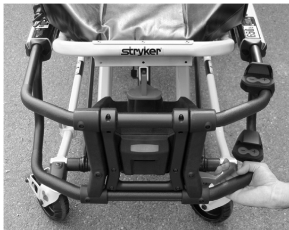
Figura 52 - Leva di rilascio manuale
