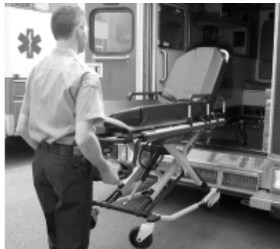
Figura 42 - Ruote di caricamento sul pavimento della vettura
