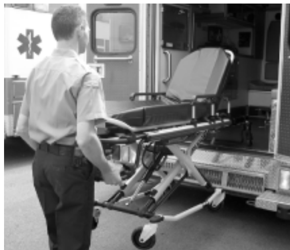
Figure 60 - Soulever les roues de charge du plancher du véhicule
