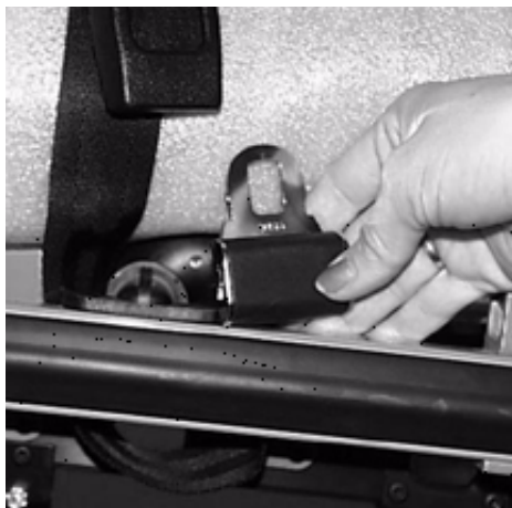
Figur 23 - Fastsättning av fastsättningsbältena på en RUGGED bårvagn
