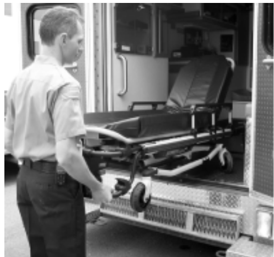
Abbildung 44 - Trage in das Fahrzeug drücken
