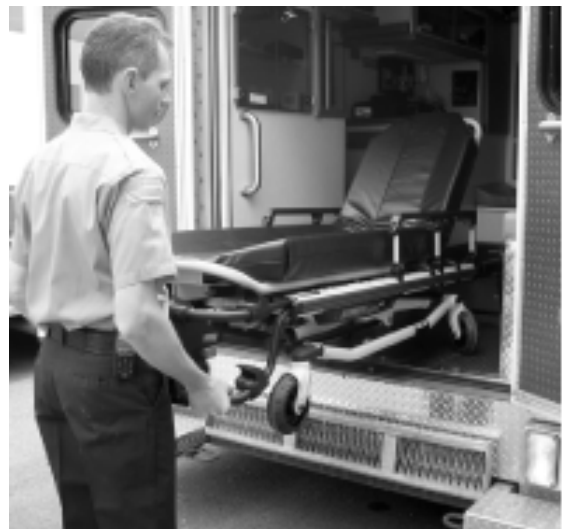
Figure 44 - Pousser la civière dans le véhicule
