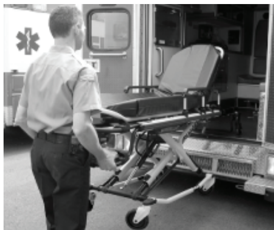
Figura 34 – Azionamento della maniglia di rilascio manuale di riserva
