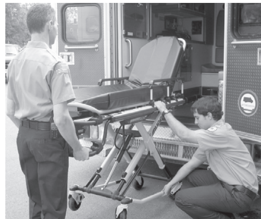
Figure 28 : 2 opérateurs, l'un soulevant la base
