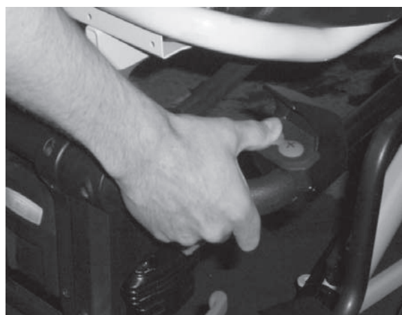
Figura 18 – Pressione del pulsante di retrazione
