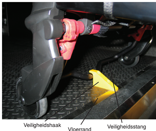
Figuur 13: Veiligheidsstang grijpt in veiligheidshaak
