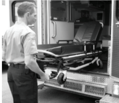
Figure 33 : Tirer la civière hors du véhicule
