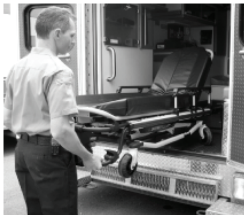
Abbildung 33: Ziehen der Trage aus dem Fahrzeug
