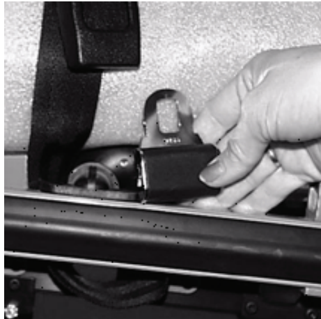
Figuur 52.3: De veiligheidsriemen op een brancard beveiligen
