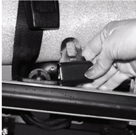
Figura 52.3 – Fissaggio delle cinghie di contenimento alla barella
