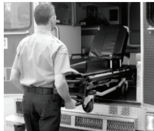
Kuva 29: Työnnä ambulanssivuode ajoneuvoon
