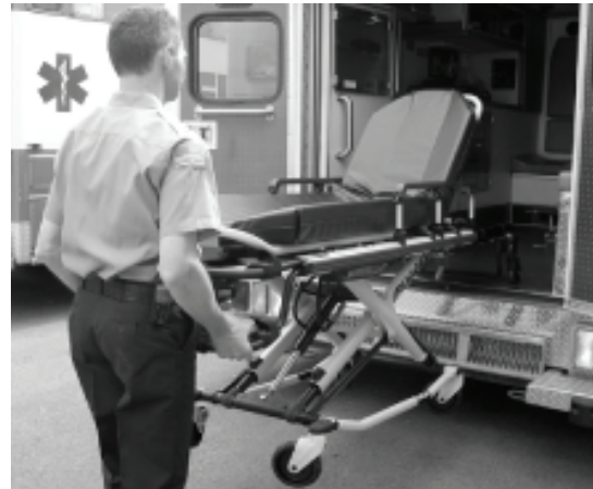
Figur 34: Træk i det manuelle reserveudløsningshåndtag
