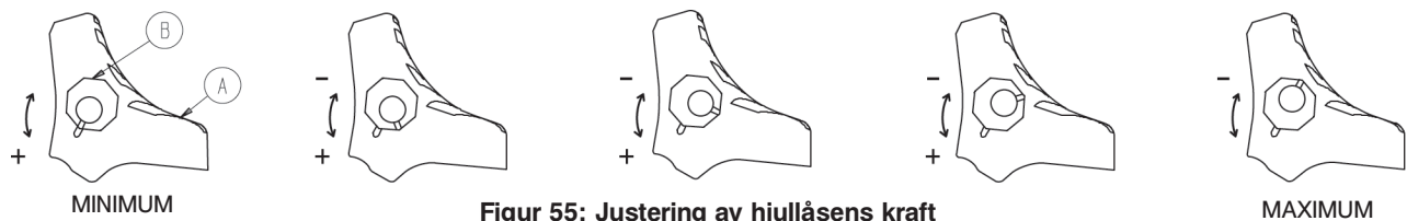
Figur 55: Justering av hjullåsens kraft
