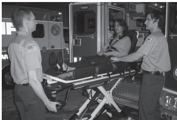
Figur 21: 2 operatører - En trykker på hæveknappen
