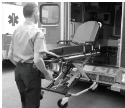
Figuur 35: De brancard uit het voertuig rollen
