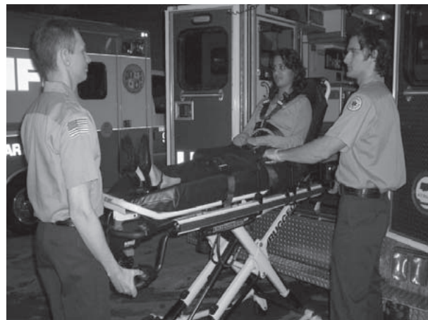
Figuur 15: 2 bedieners – Eén drukt op de intrekknop
