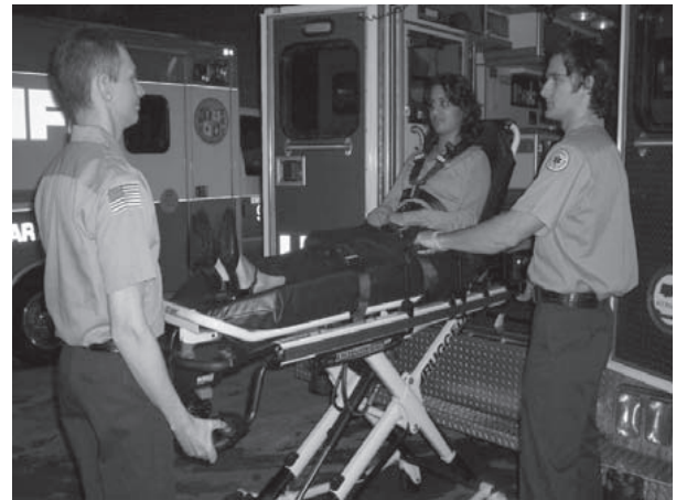
Figure 15 : 2 opérateurs, l'un appuyant sur le bouton de repliement
