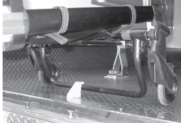
Figur 14: Sikkerhedsstangen griber fat i sikkerhedskrogen
