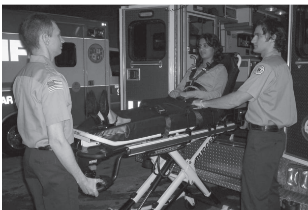
Figuur 31: 2 bedieners – Eén drukt op de uitschuifknop
