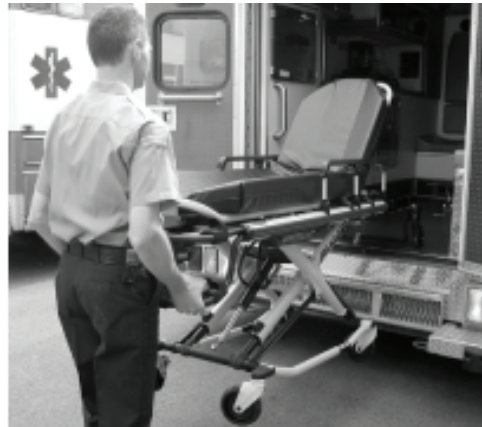
Figuur 17: Laadwielen op de vloer van het voertuig
