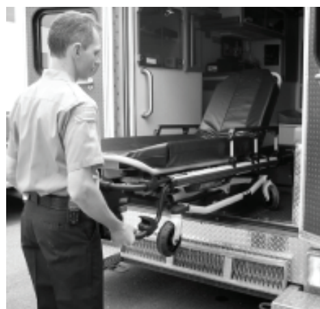
Abbildung 19: Schieben der Trage in das Fahrzeug
