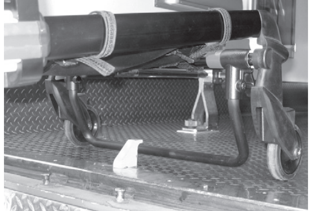
Figure 14 : Barre de sécurité engageant le crochet de sécurité
