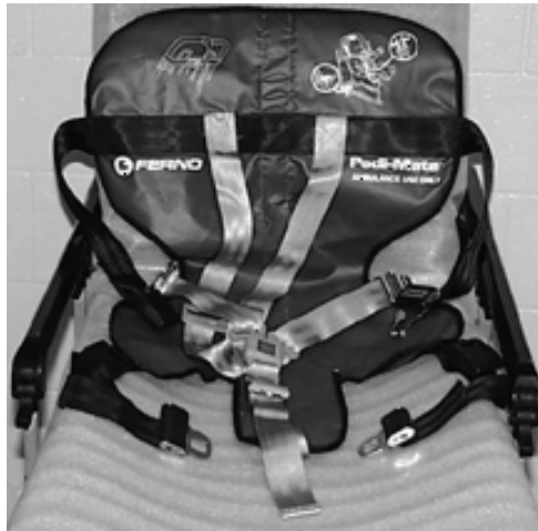
Figura 52.1 – Posizionamento del Pedi-Mate®
