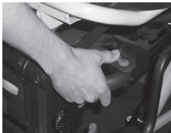
Figure 18 : Appuyer sur le bouton de repliement
