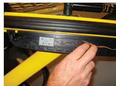
Abbildung 4.4: Sichern der Kabel
