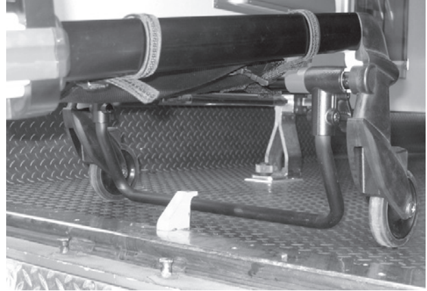
Kuva 14: Turvatangon kiinnittyminen turvakoukkuun
