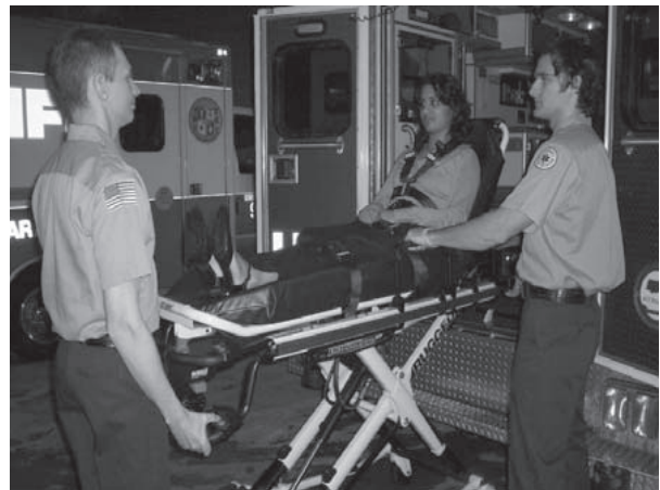
Figur 15: 2 operatører - En trykker på sænkeknappen
