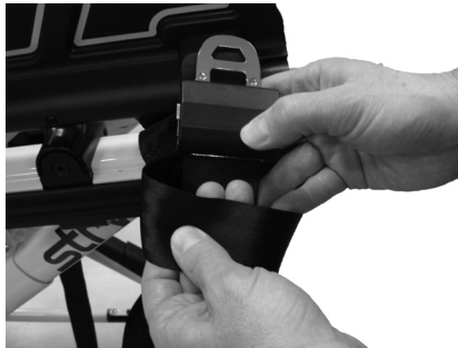
Figura B – Spingere la fibbia attraverso il passante
