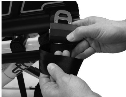
Figur B: Tryck spännet genom öglan
