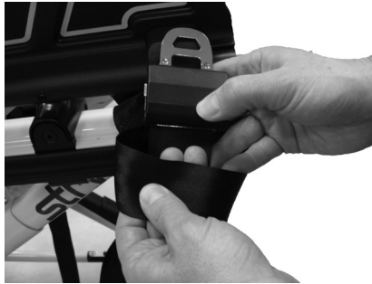
Figur B: Skub spændet igennem løkken
