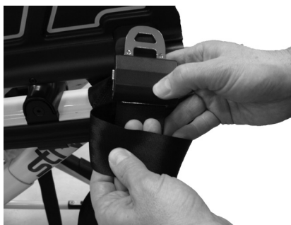
Obrázek B: Provlékněte sponu smyčkou
