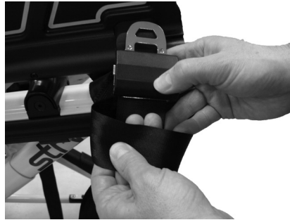
Abbildung B: Gurtschloss durch die Schlaufe führen
