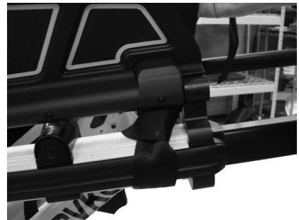
Figure C : Tirer la sangle pour serrer
