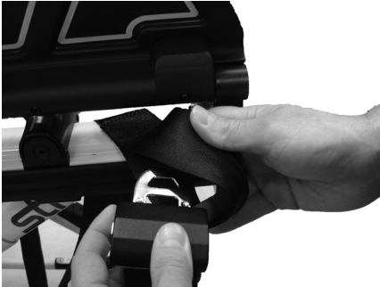
Figura A: Enrolar a correia à volta da maca
