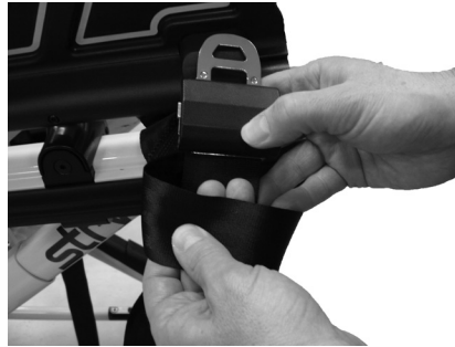
Figura B: Empurrar a fivela pela presilha
