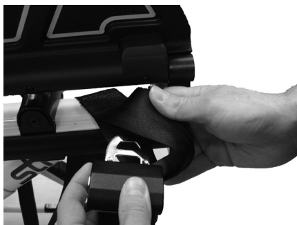
Obrázek A: Oviňte pás kolem lůžka
