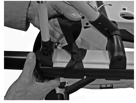
Σχήμα 19 – Στερεώστε τον ιμάντα συγκράτησης στο φορείο
