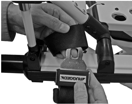
pav. 17 – Apjuoskite saugos diržą apie neštuvų rėmą
