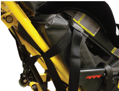
Figura 30 – Ubicación de la correa de anclaje
