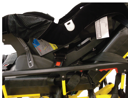
Slika 31 – Pritrdite varovalni pas za okoli pasu
