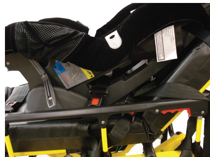
Slika 31 – Učvrstite sustav za vezivanje struka
