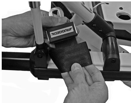
Rysunek 18 – Przeprowadź sprzączkę pasa unieruchamiającego przez pętlę
