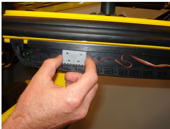
Obrázek 12 – Upravte nastavení levého senzoru výšky
