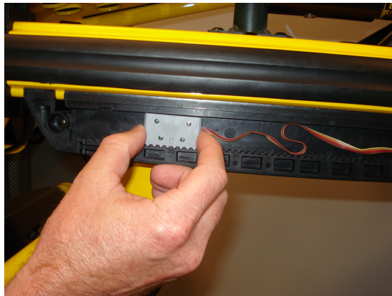
Figura 12 – Ajustar a altura do sensor esquerdo
