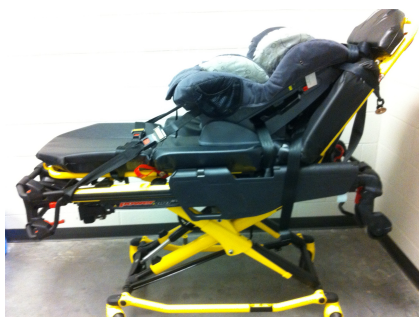
Rysunek 32 – Mocowanie do rurek podnoszących po stronie stóp pacjenta
