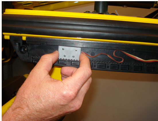
pav. 12 – Sureguliuokite kairiojo jutiklio aukštį
