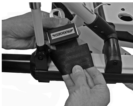
Obrázek 18 – Vzniklou smyčkou provlékněte sponu upínacího pásu
