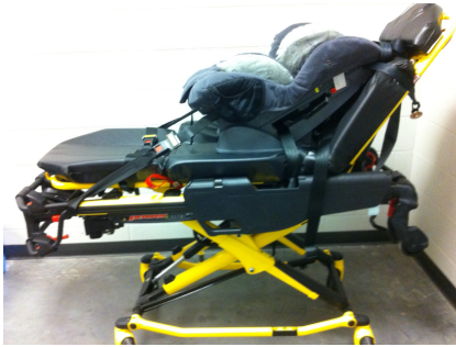
Şekil 32 – Ayak ucu kaldırma çubuklarına takın
