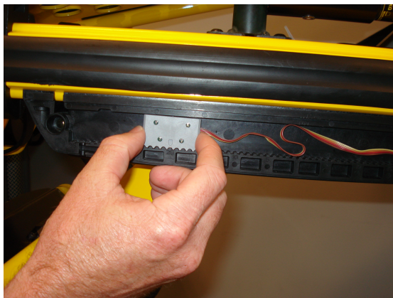
Figura 12 – Reglați înălțimea senzorului din stânga
