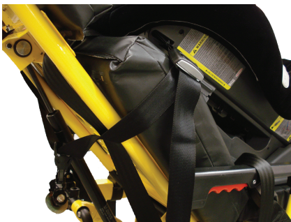
Slika 30 – Lokacija sidrenog remena
