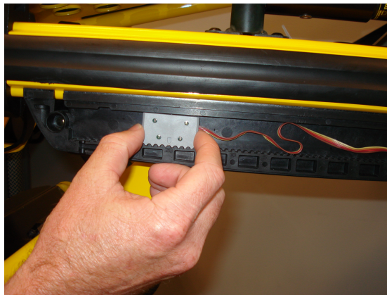
Figura 12 – Regolare l'altezza del sensore sinistro
