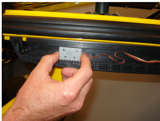
Σχήμα 12 – Ρύθμιση ύψους αριστερού αισθητήρα
