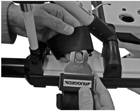
Kuva 17 – Kiedo kiinnityshihna ambulanssiparien rungon ympäri
