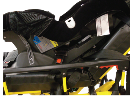
图 31 – 固定腰部约束装置
