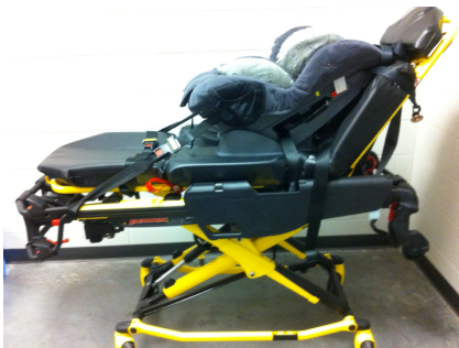
Σχήμα 32 – Σύνδεση στις ράβδους ανύψωσης της πλευράς ποδιών
