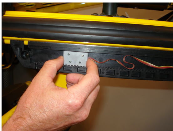
Рисунок 12 – Регулировка левого датчика высоты
