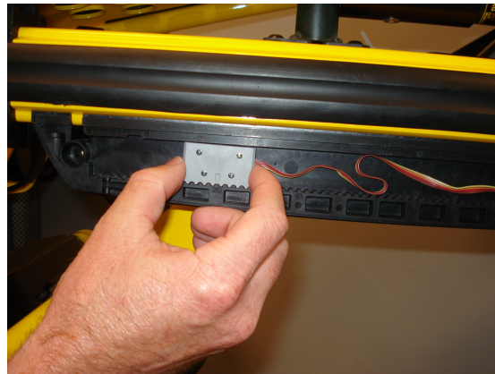
Slika 12 – Podesite visinu lijevog senzora
