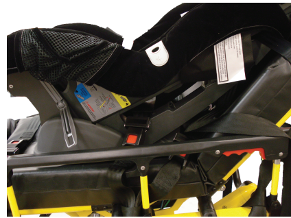
pav. 31 – Juosmens fiksavimo diržo tvirtinimas
