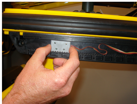
Figure 12 – Régler la hauteur du capteur gauche
