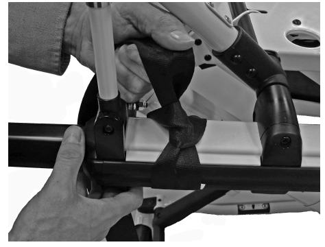
pav. 19 – Pritvirtinkite saugos diržą prie neštuvų
