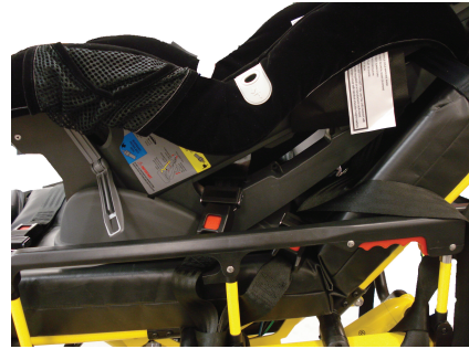
Joonis 31 – Kinnitage vöökinnitus
