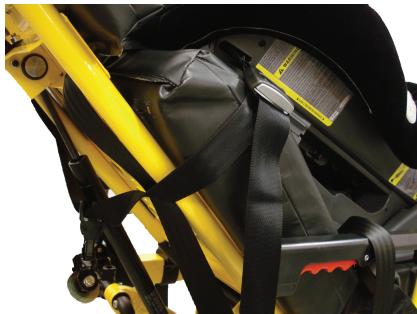
Figura 30 – Ubicación de la correa de anclaje
