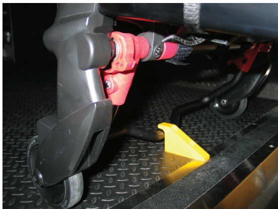
Obrázek 9 – Bezpečnostní tyč zaklesnutá za bezpečnostní hák ve vozidle
