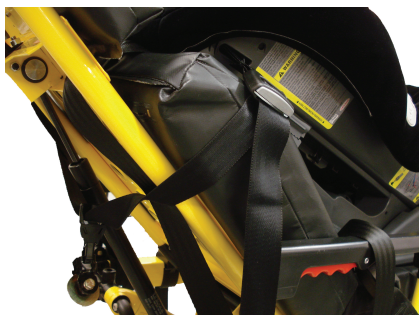
Obrázek 30 – Umístění kotevního pásu
