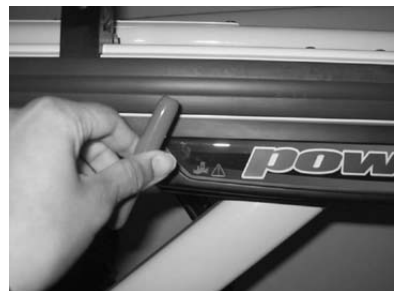
Figura 5: Extracción de los tornillos
