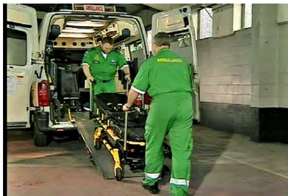
Figur 14 – Led båren opp midten av rampen
