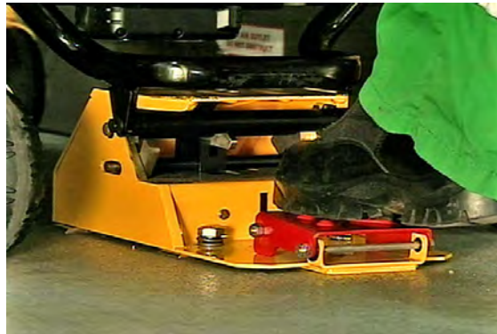
Slika 10 – Pritisnite nožnu papučicu
