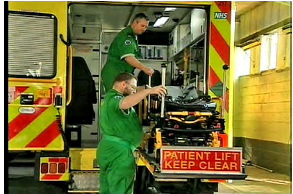
Kuva 12 – Molemmat kantajat ohjaavat parit ajoneuvon potilasosastoon
