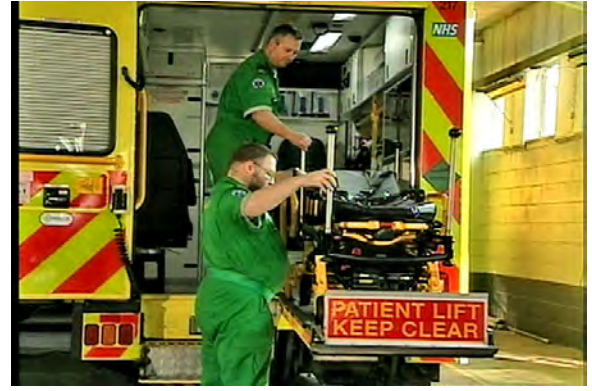
Şekil 12 – Her iki operatör de karyolayı araç hasta bölmesine yönlendirmelidir
