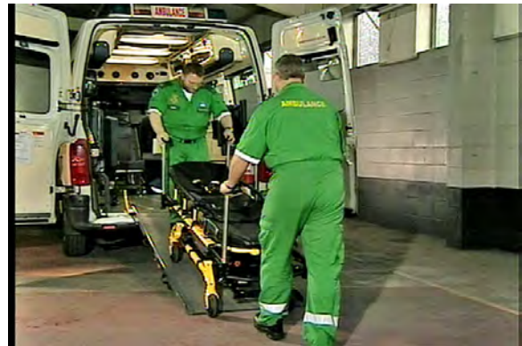
Slika 14 – Vodite krevet sredinom rampe
