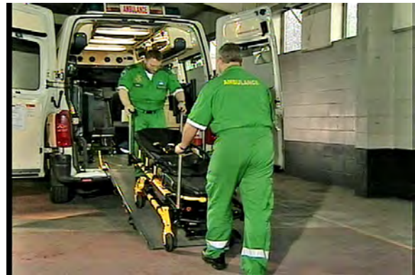
Kuva 14 – Ohjaa parit luiskan keskiosaa pitkin ylös
