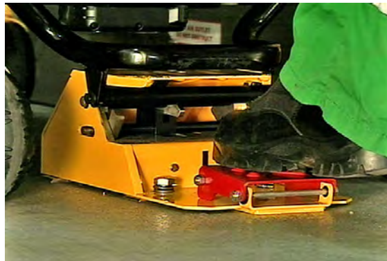
Figur 10 – Trykk ned på fotpedalen
