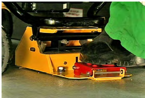
Figura 10 – Premere il pedale
