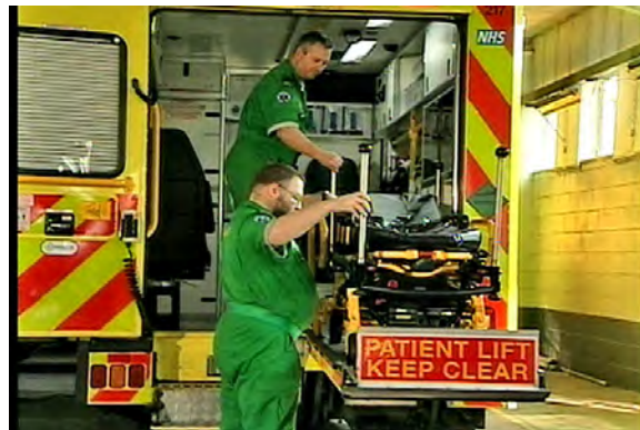
Slika 12 – Oba uporabnika vodita nosila v predel vozila za bolnika
