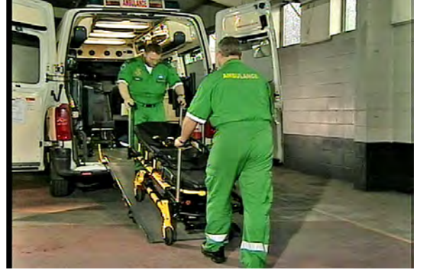
řekil 14 – Karyolayı rampanın merkezine ynlendirin
