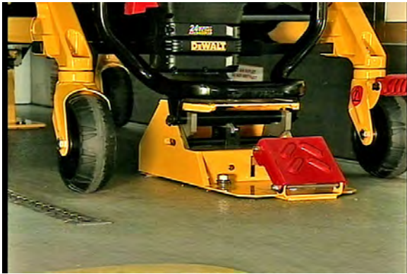
Figur 8 – Bårvagn i både huvudändan och fotändan av bårvagnsfästet
