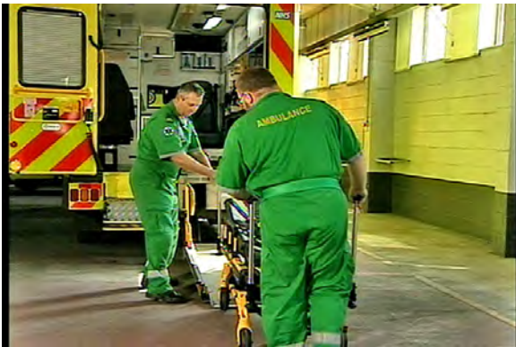
Figur 11 – Bårvagn på bakgavellyften
