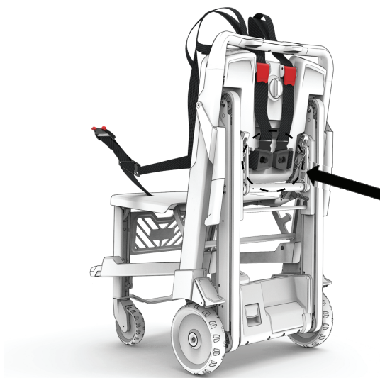
Figure 22 – Emplacement de connexion du clip du relève-buste au montant
