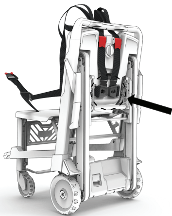
Рисунок 25 – Закрепите защелку плечевого ремня в защелке ремня спинки
