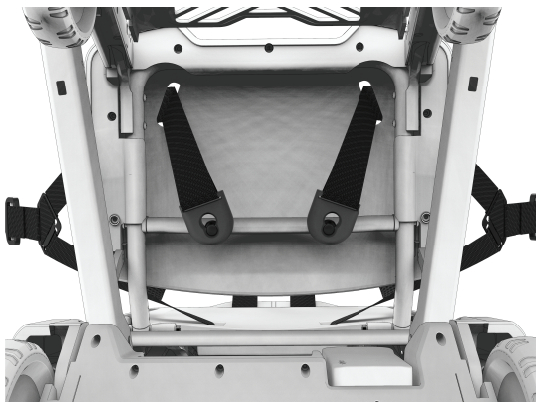
Figure 18 – Montant du siège, parallèle
