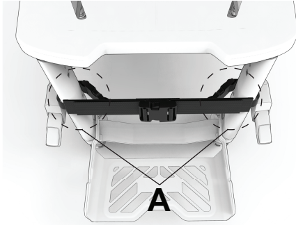
Figur 28 – Koble til sideutløaserspennene
