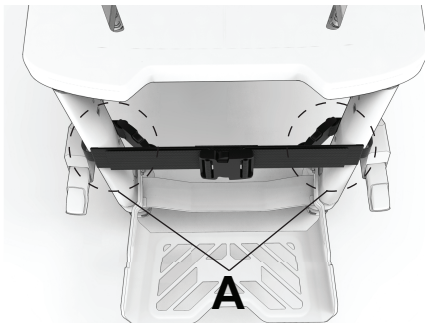
Figura 28 – Conecte las hebillas de liberación laterales
