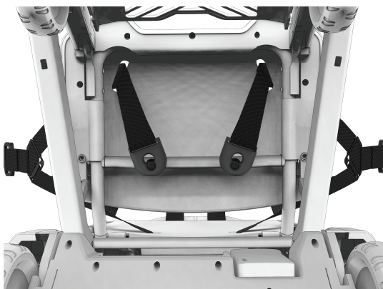
Рисунок 18 – Стойка сиденья, параллельная конфигурация
