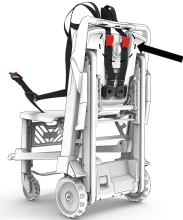
Kuva 26 – Olkapään kiinnityshihnan kiristäminen tai löysäminen PCS-nokkia nostamalla
