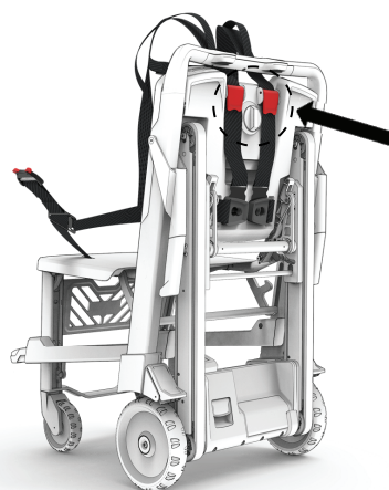
Figura 26 – Ridicarea camei SRP pentru a strânge sau a slăbi cureaua de prindere pentru umăr
