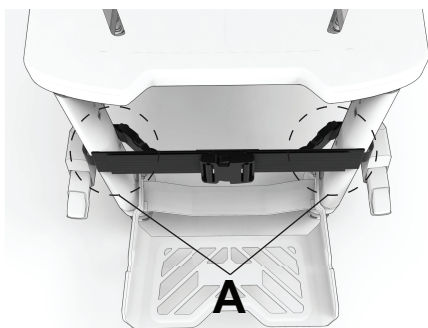
Figure 28 – Connecter les boucles latérales
