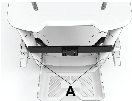
Afbeelding 28 – De gespen van de zijontgrendelingen bevestigen
