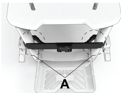
Ábra 28 – Csatlakoztassa az oldalsó kioldócsatokat
