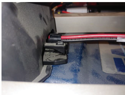
Obrázek 14 – Zatlačte konektor do dutiny
