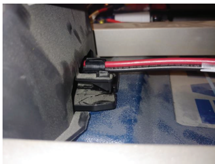
Slika 14 – Priključek potisnite v odprtino
