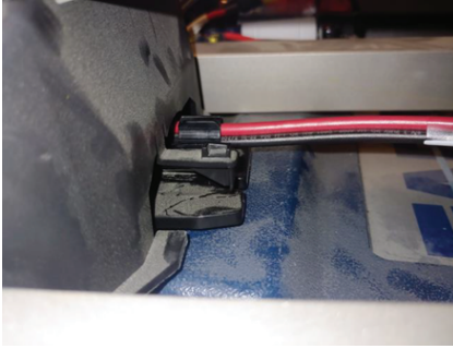
Şekil 14 – Konektörü kaviteye ittin
