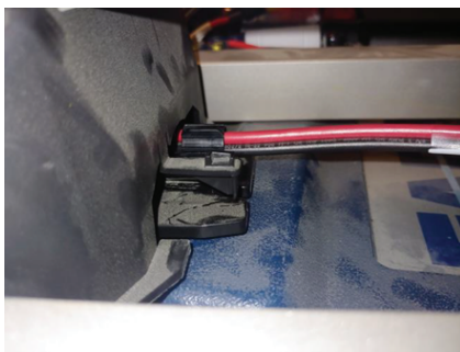
Figur 14 – Skyv kontakten inn i hulrommet.
