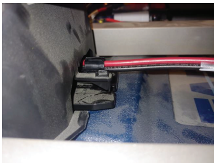
Rysunek 14 – Wcisnąć złącze do wnęki
