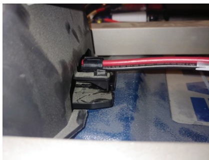
Joonis 14 – Lükake konnektor süvendisse
