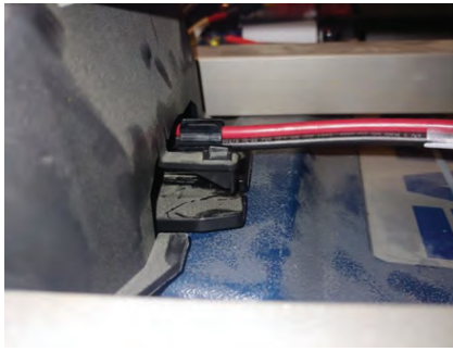
Figura 14 – Empuje el conector en la cavidad
