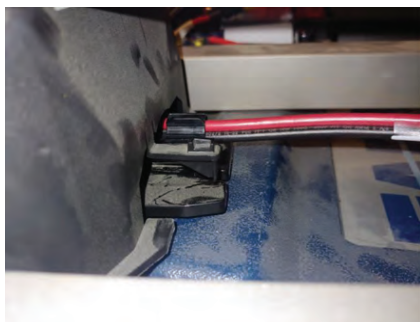
Рисунок 14 – Вставьте разъем в полость
