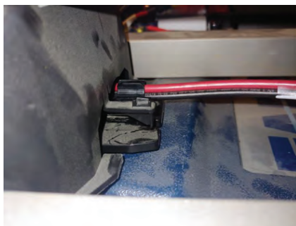
Joonis 14 – Lükake konnektor süvendisse
