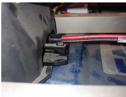
Figura 14 – Empurre o conector para a cavidade
