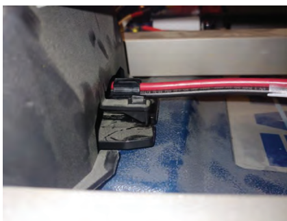
Ábra 14 – Nyomja be a csatlakozót a mélyedésbe.
