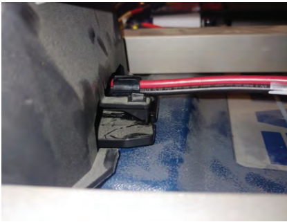
Şekil 14 – Konektörü kaviteye ittirin
