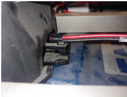
Figure 14 – Enfoncer le connecteur dans la cavité
