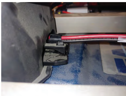
Afbeelding 14 – Duw de connector in de opening
