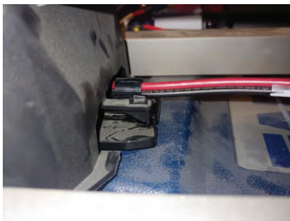
Figura 14 – Împingeți conectorul în cavitate
