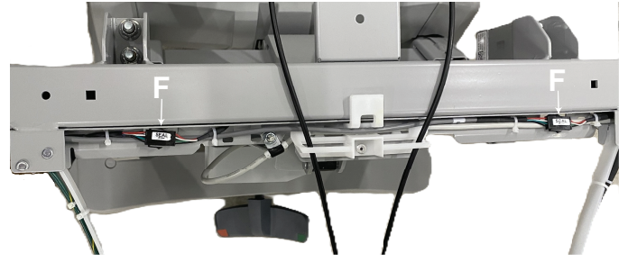
Şekil 10 – Ayak ucu kurcalama önleme etiketleri
