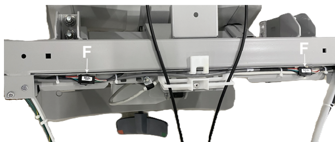
Slika 10 – Oznake protiv neovlaštenog zahvata na donjem kraju
