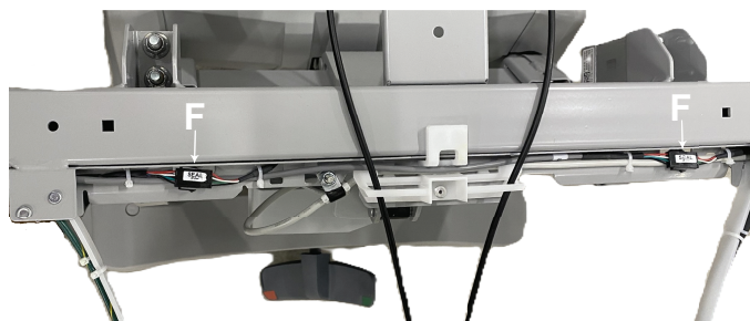
図 10 – 足側端部の不正使用防止ラベル
