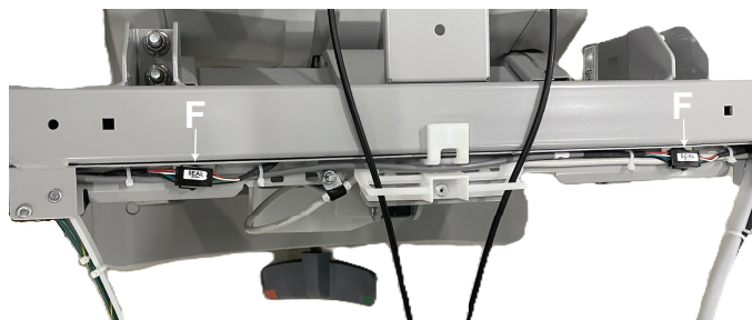
Figur 10 – Antisabotasjeetiketter for fotenden
