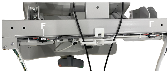
Figura 10 – Rótulos antiadulteração na extremidade do lado dos pés
