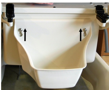
Figura 48 – Levantamiento del recipiente para fluidos
