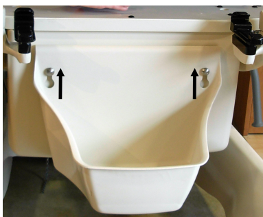
Figure 48 – Soulèvement du bassin collecteur de liquides
