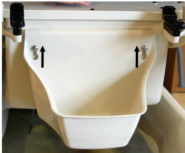
Figure 2-48 : Souèvement du bassin
