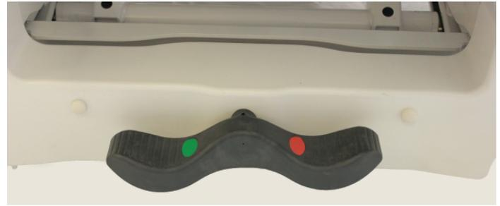
Figure 9 – Désenclenchement du verrou de direction/position neutre
