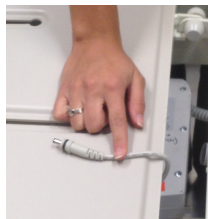
Figure 5 – Débranchement du câble de la batterie du boîtier de contrôle
