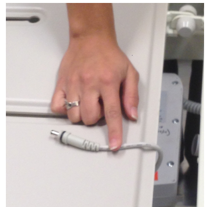
Ábra 5 – Az akkumulátorkábel lecsatlakoztatása a vezérlődobozról
