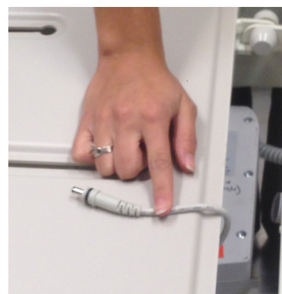
Figura 5 – Scollegamento del cavo della batteria dalla centralina di comando
