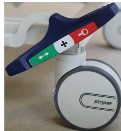
図 11 – 第5輪を作動させる
