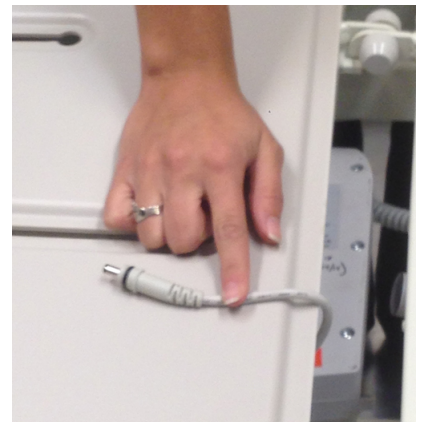
그림 5 – 배터리 케이블을 컨트롤 상자에서 빼기
