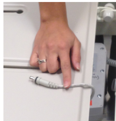
Figura 5 – Desligar o cabo da bateria da caixa de controlo
