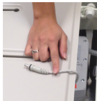
Figura 5 – Debloarea cablului pentru baterie de la caseta de comandă
