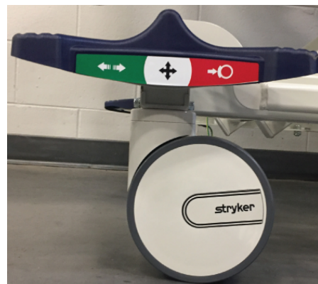
Рисунок 12 – Втягивание пятого колеса
