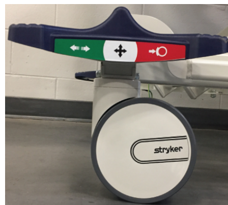
Рисунок 10 – Отпускание педали фиксатора поворотного ролика
