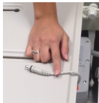
Рисунок 5 – Отсоединение кабеля батареи от блока управления
