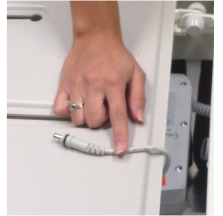
Şekil 5 – Batarya kablosunun fişini kontrol kutusundan çekme
