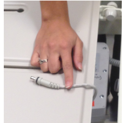
Şekil 5 – Batarya kablosunun fişini kontrol kutusundan çekme
