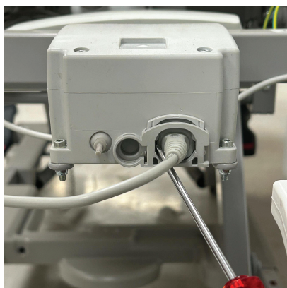
Σχήμα 9 – Ωθηση προς τα μέσα της ασφάλειας του καλωδίου ρεύματος
