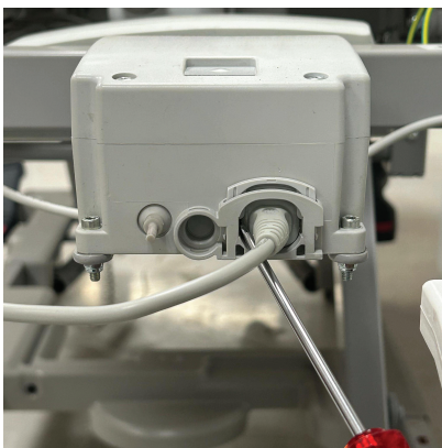
Figura 9 – Introducción del seguro del cable de alimentación
