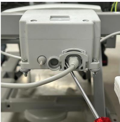
Figura 9 – Introducción del seguro del cable de alimentación
