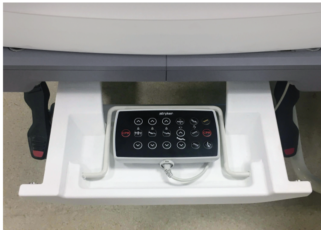
Figura 31 – Conservazione della pulsantiera di comando per l'infermiere
