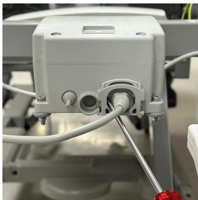
Figura 9 – Împingerea dispozitivului de blocare a cablului de alimentare
