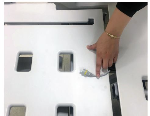
Рисунок 10 – Отсоединение кабеля батареи от батареи
