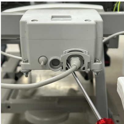
Obrázok 9 – Zasunutie zámku napájacieho kábla
