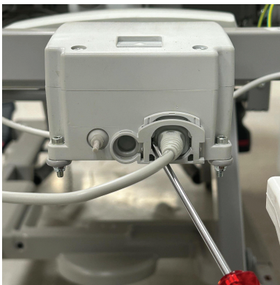
Slika 9 – Potiskanje zaklepa napajalnega kabla navznoter
