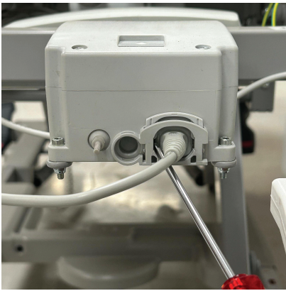
Şekil 9 – Güç kablosu kilidini içeri itme
