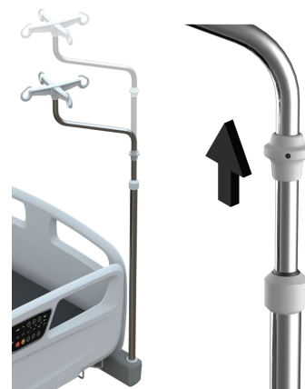
图 32 – 静脉输液架的调节能力
