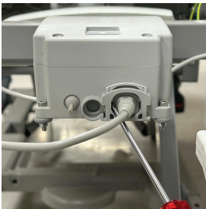
Rysunek 9 – Wcisnięcie blokadę przewodu zasilania
