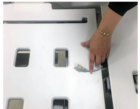
Rysunek 10 – Odłączenie wtyczki przewodu baterii od baterii
