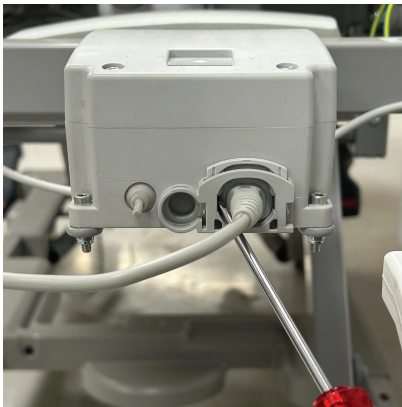
Kuva 9 – Virtajohdon lukon työntäminen sisään
