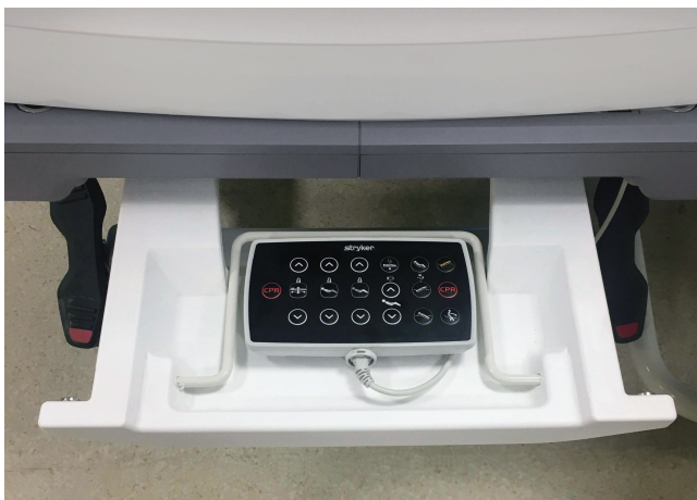
Figura 31 – Depozitarea casetei suspendate cu butoane de comandă pentru asistenta medicală
