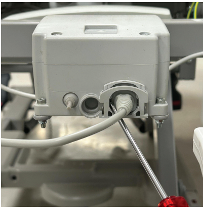
Şekil 9 – Güç kablosu kilidini içeri itme
