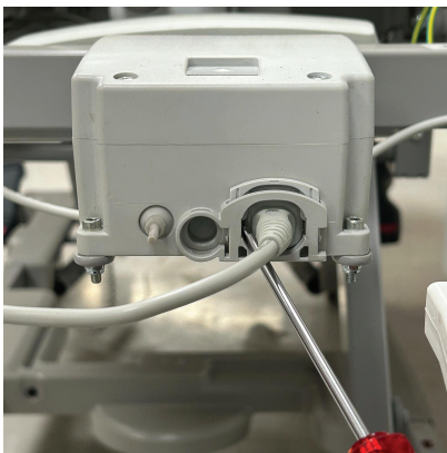
Figure 9 – Enfoncement du verrou du cordon d'alimentation
