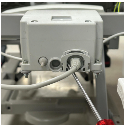
Figura 9 – Inserimento del blocco del cavo di alimentazione
