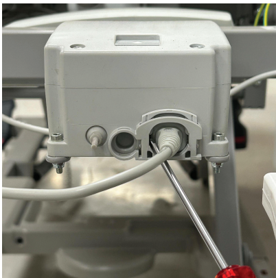
Figur 9 – Skyve inn på strømledningslåsen
