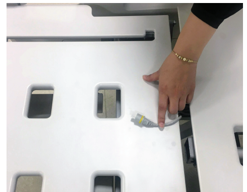
Afbeelding 10 – De accukabel loskoppelen van de accu
