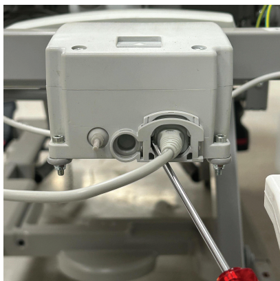
Obrázek 9 – Zatlačení na zámek napájecího kabelu
