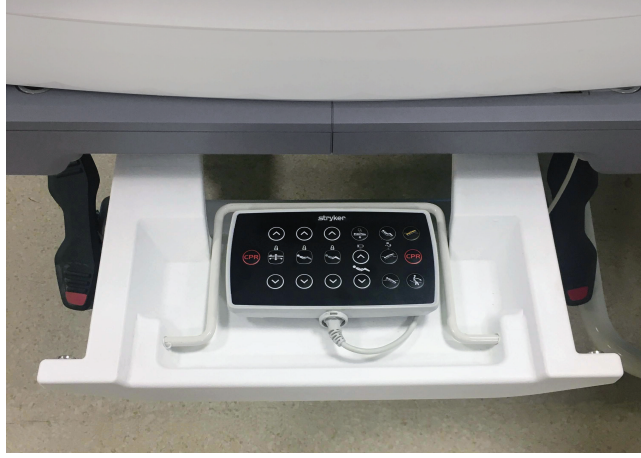
Şekil 31 – Hemşire kontrol el kumandasını saklama
