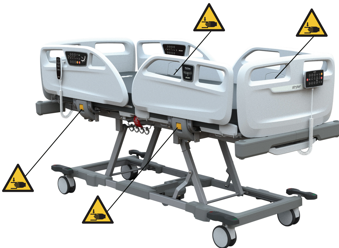
Slika 1 – Mesta možnega ukleščanja, premične in nepremične vzglavne plošče postelje ProCeed
