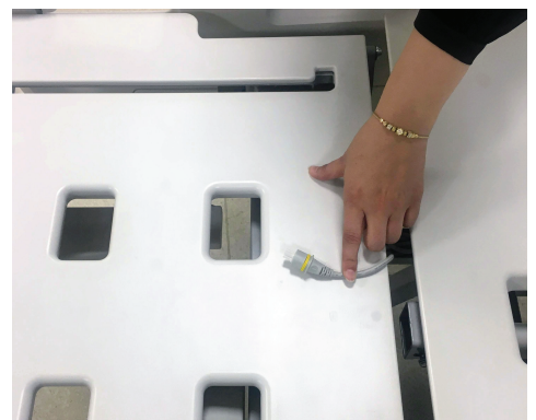
Figura 10 – Desligar o cabo da bateria da bateria
