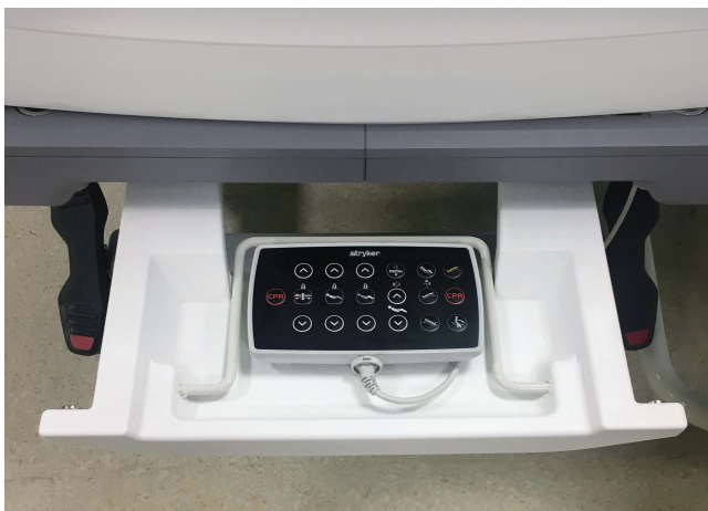
Figura 31 – Conservazione della pulsantiera di comando per l'infermiere
