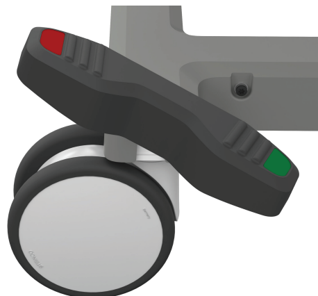
Obrázek 13 – Použití zámku řízení Steer-Lock
