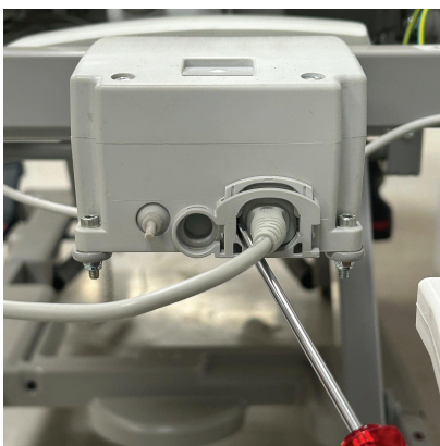
Figura 9 – Empurrar o bloqueio do cabo de alimentação
