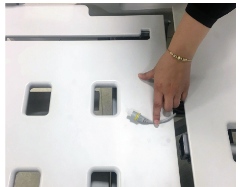
Figure 10 – Débranchement du câble de la batterie de celle-ci
