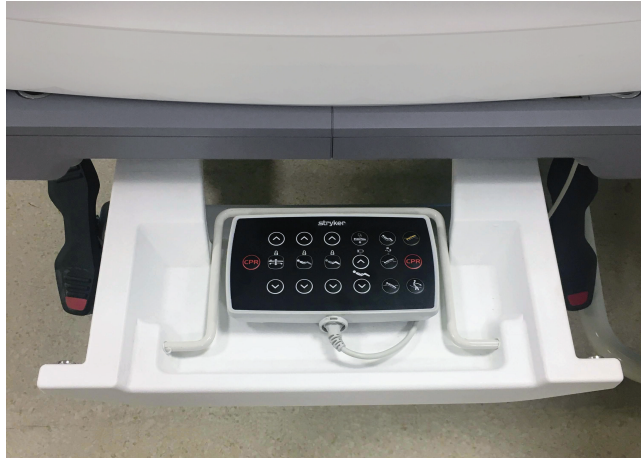
Obrázek 31 – Uložení závěsného ovladače pro sestry
