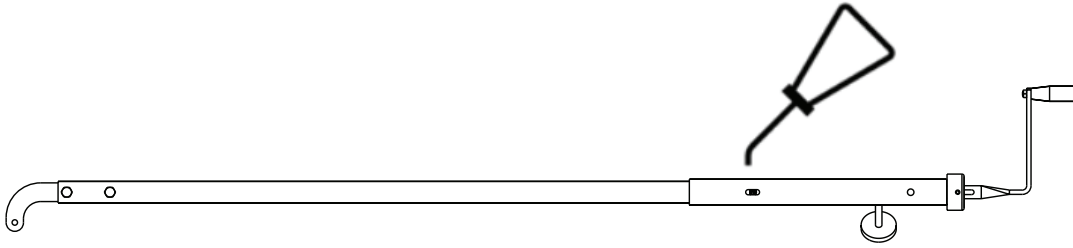
Σχήμα 16 – Λίπανση της μανιβέλας
