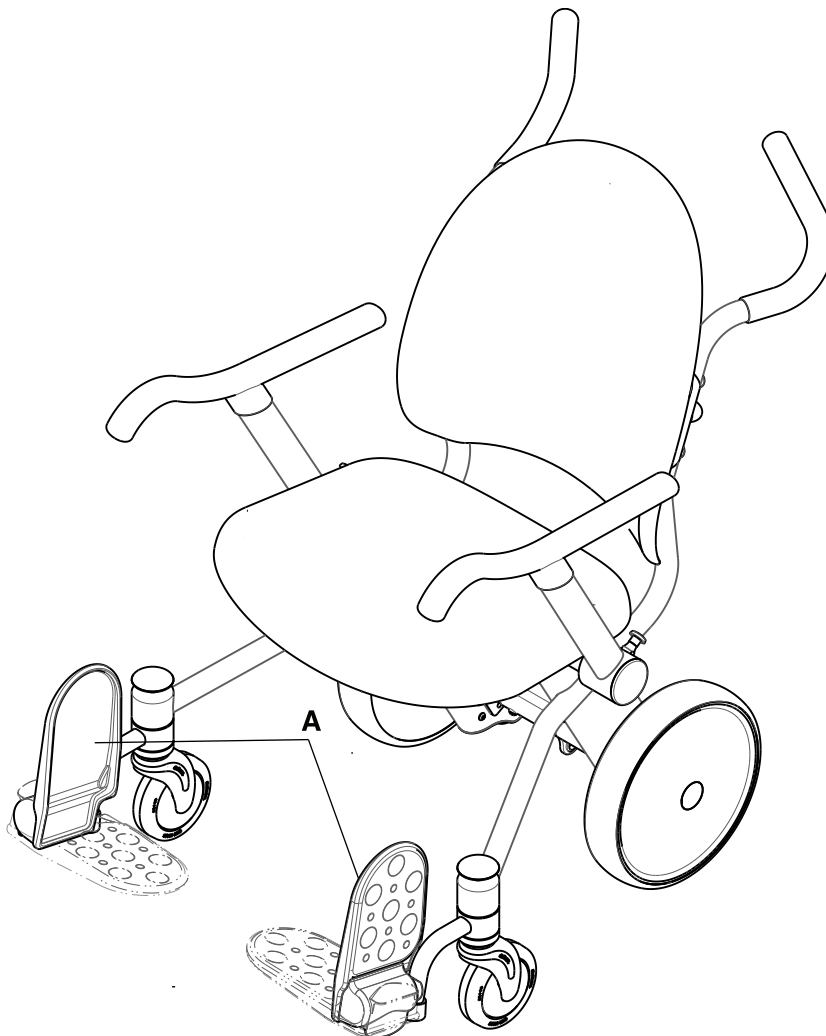
Abbildung 3-8: Hochklappbare Fußstützen in Lagerstellung
