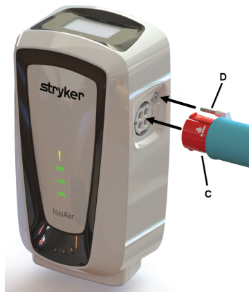
Figur 17 – Koppla ihop HLR-kopplingen och AST-kabeln
